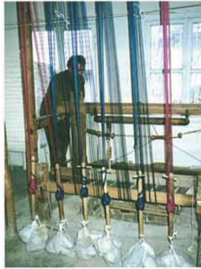
Res. 28. İpekli "Mozer peştemali" üretilen el tezgâhı, Habib Dışkaya atölyesi.
